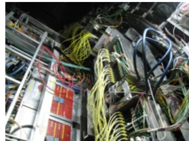
EMCaI 検出器, SRU読み出し へのアップグレード
