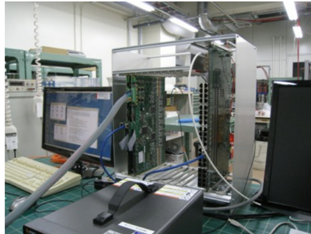
ALICE FEE-SRU テストベンチ (@筑波大) 広島・筑波で共同利用
