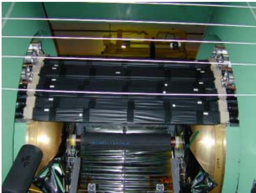
図 4.15: PHENIX 検出器に設置された T0 カウンター
